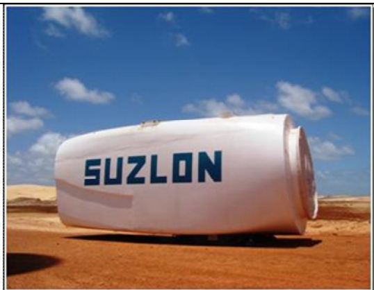
Figura 39 - Caixa do Gerador
